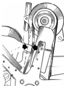
Рис. 53. Проверка натяжения ремня генератора
