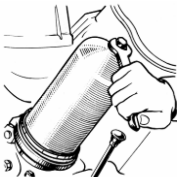
Рис. 61. Отвертывание колпака фильтра
