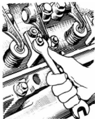
Рис. 81. Отвертывание гайки скобы крепления форсунки
