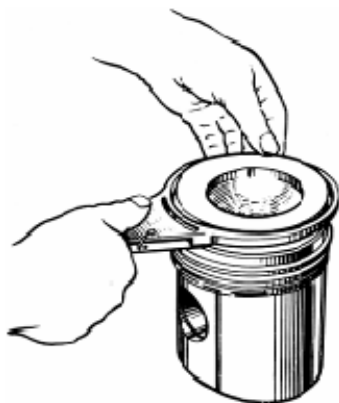
Рис. 80. Снятие и надевание поршневых колец на поршень
